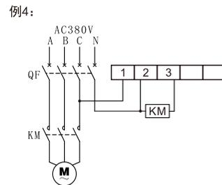
1、单相负载时，若负载阻性电流 $\leq 3A$ 或感性电流 $\leq 0.5A$ 时，继电器直接控制，接线参考例1；若负载阻性电流 $>3A$ 或感性电流 $>0.5A$ 时，继电器通过交流接触器扩容，接线参考例2；三相负载时，交流接触器和继电器电源为AC380V时，接线参考例3；交流接触器和继电器电源为AC220V时，接线参考例4。
