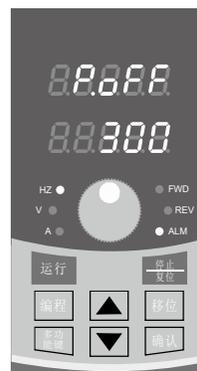
图4-2 上电参数显示状态
