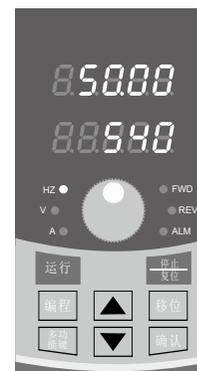
图4-3 停机参数显示状态
