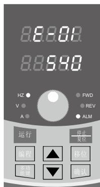
图4-5 加速中过流故障报警显示
