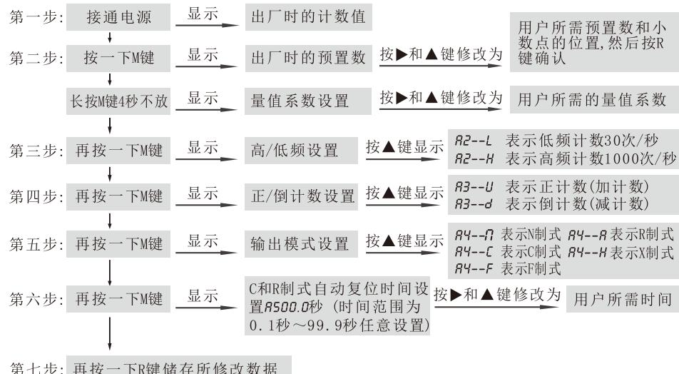
注：1、第二步预置数设置时连续按“▶”键将依次移动万位、千位、百位、十位、个位后的小数点闪烁，然后按“▲”键加数字和移动小数点的位置；
