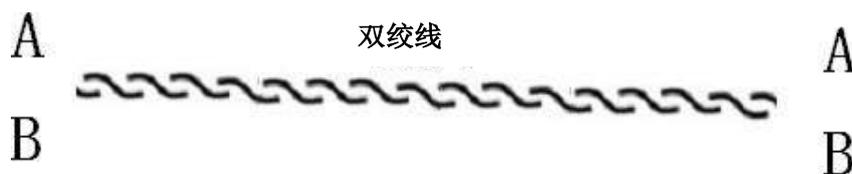
A 接 A、B 接B，如果一个主站多个从站，只需将所有的A 相连，所有的B 相连。
