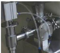
在灌装机应用中，需要通过控制液体阀门的打开时间来控制液体的罐装容量；为了提高瓶中所灌装液体的容量精度，可以选用精确定时来控制液体阀门打开的时间。
