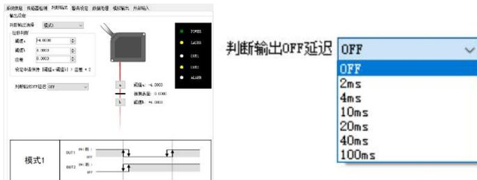
打开 C-Lin LASER STUDIO-1 设定软件选择判断输出，点击选择判断 off 输出延迟并设定。
