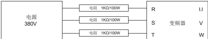
图 9-1 380V 驱动装置充电电路示例
